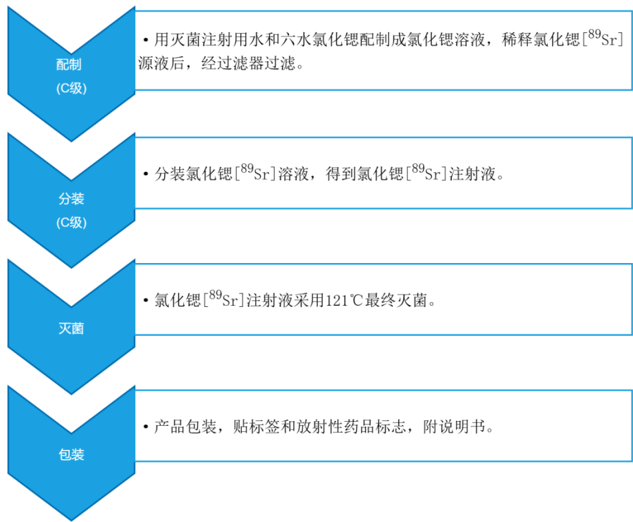
图 6. 氯化锶[ 89 Sr]注射液生产工艺流程图（示例）
